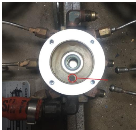
Foto 6. Filtro de malla de la unidad de distribución de combustible a los inyectores muestra residuos sólidos
