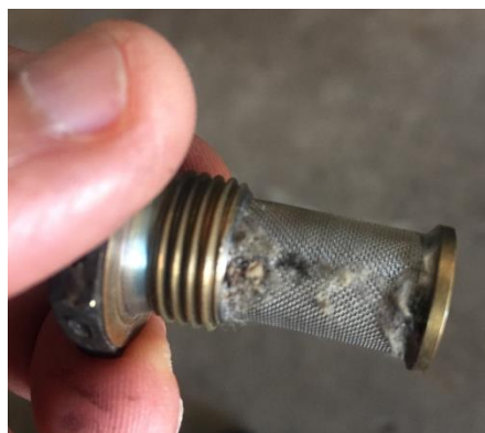
Foto 5. Filtro de malla de la unidad de control de combustible muestra residuos sólidos
