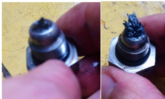
Fotos 9 y 10 detector superior e inferior colmados de partículas
