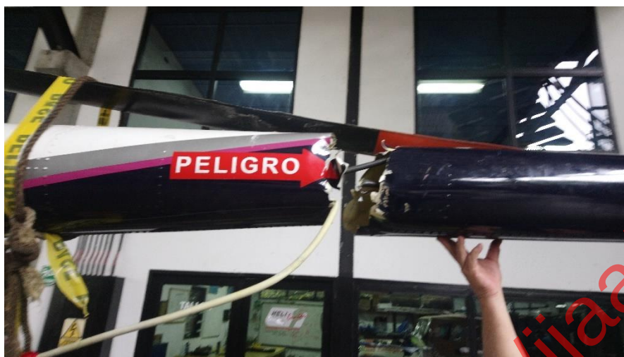
Foto 6. El botalón de cola fue arrancado al impactar el estabilizador vertical.
