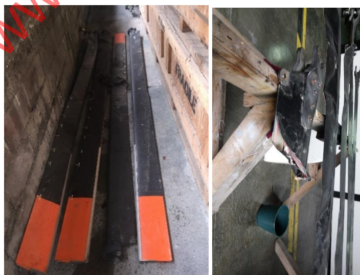
Foto 5. De las cinco palas del rotor principal se recuperaron cuatro, tres sostenidas al mástil una que se desprendió y la quinta pala se fracturó en la raíz y se pudo recuperar solamente la raíz.
