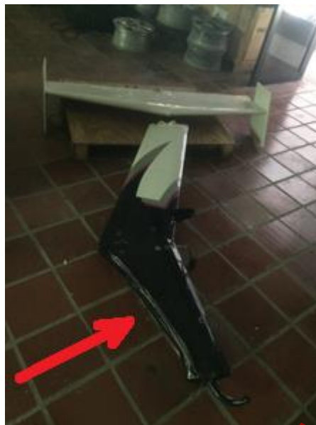
Foto 3. La sección inferior del estabilizador vertical tiene impacto en el borde de ataque, esto ocurrió al impactar la aeronave con un ligero ángulo de nariz arriba, golpea al fuselaje en la parte inferior trasera y el estabilizador vertical en su sección inferior, se hunde en el agua golpeándose, lo cual provoca que se frene el empenaje halando el botalón que es arrancado quedando fracturado en su sección media.
