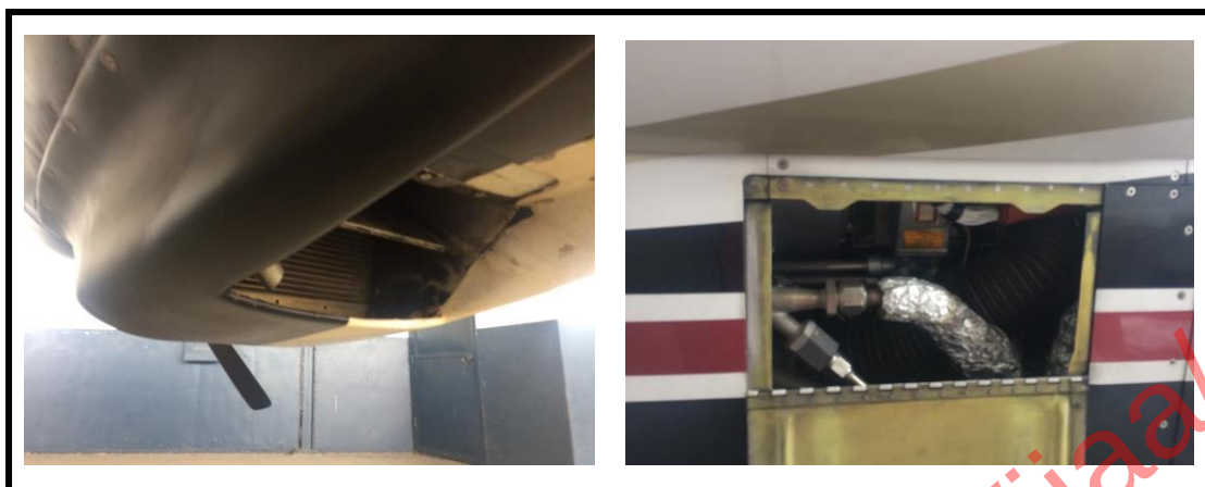
Figura 2. Verificación de fugas de aceite en el motor y en la bandeja de recolección de líquidos en la Aeronave YV2986. Fuente: Investigador Encargado. Año: 2022
