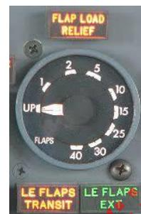
Fotografía 2. Reloj de configuración de Flaps en el Panel de Control
