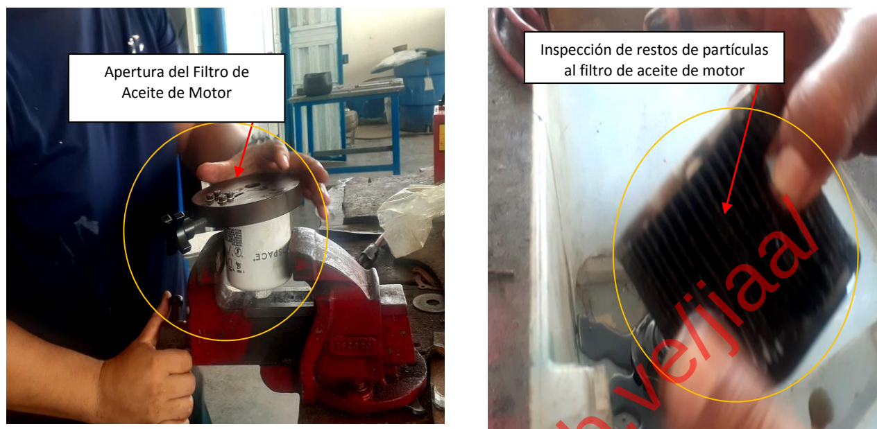
Figura 6. Inspección del filtro de Aceite del motor del YV184E.
