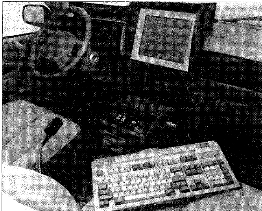
Figura 5-7. Unidad de presentación, en pantalla fluorescente de vacío, y teclado en el vehículo medidor del rozamiento en la pista
