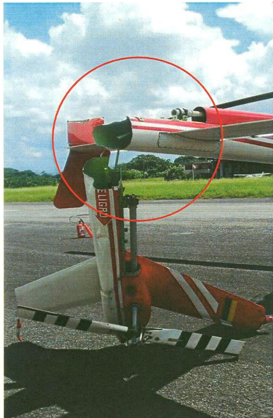
Ubicación de la aeronave con respecto a los restos y detalle del eje de transmisión del rotor de cola.
