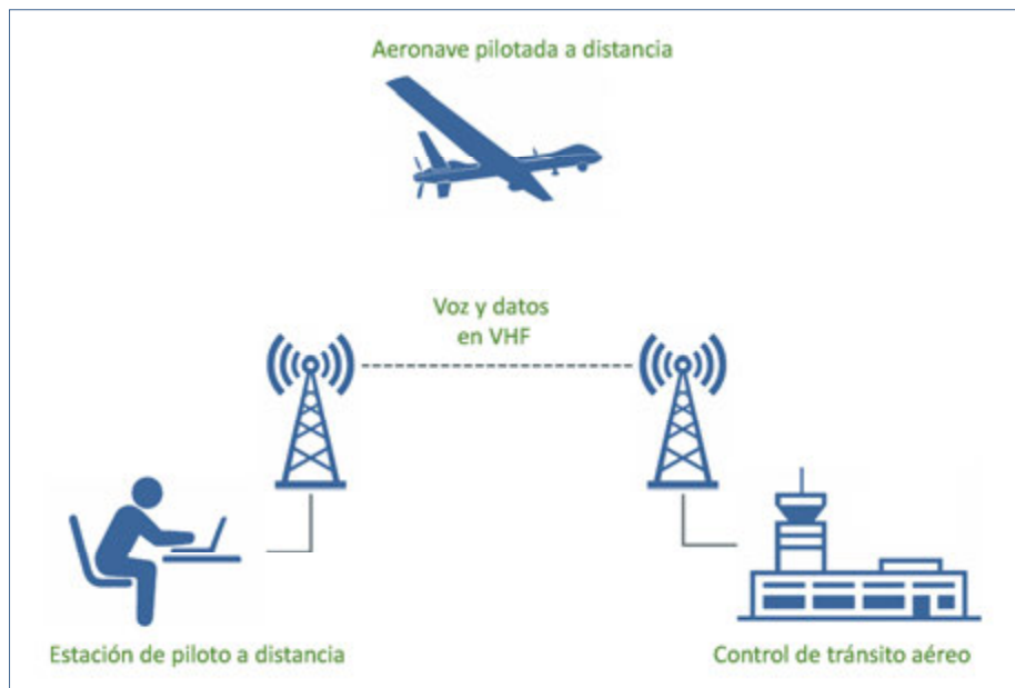
Figura 12-4. Enlace de radio VHF tierra-tierra
