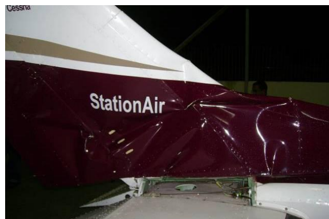
♦ Vistas laterales del estabilizador vertical mostrando los daños producidos.
