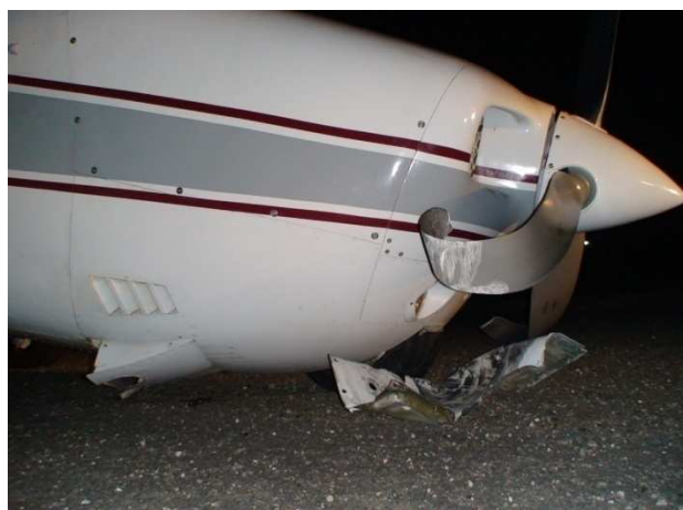
Fig. 2 Daños en la nariz de la aeronave
