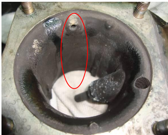
La grafica muestra la ausencia del inyector de combustible.
