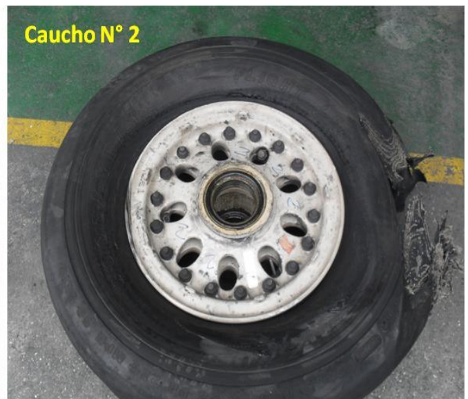
Figura 3. Condición final de los cauchos del tren principal izquierdo (cauchos 1 y 2). Fuente (2012).
