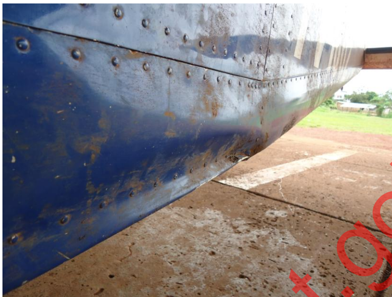
Fotografía 2. Abolladura en la sección posterior del fuselaje.
