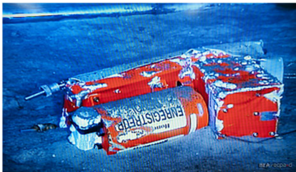
Figura I-5-5. Registrador de datos de vuelo (FDR) de un Airbus A330 fotografiado a una profundidad 3 900 m en el Océano Atlántico (accidente de 2009)
