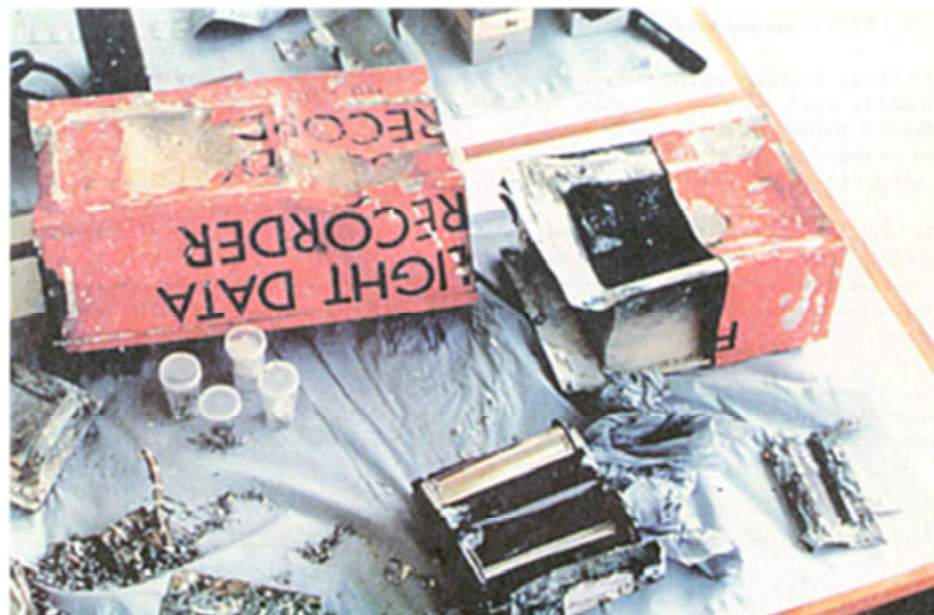
Figura I-5-10. FDR de un DC-9 exhibiendo poca corrosión después de estar sumergido 12 años en el mar Mediterráneo (accidente de 1980)
