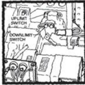
LANDING GEAR MOTOR AND GEARBOX
